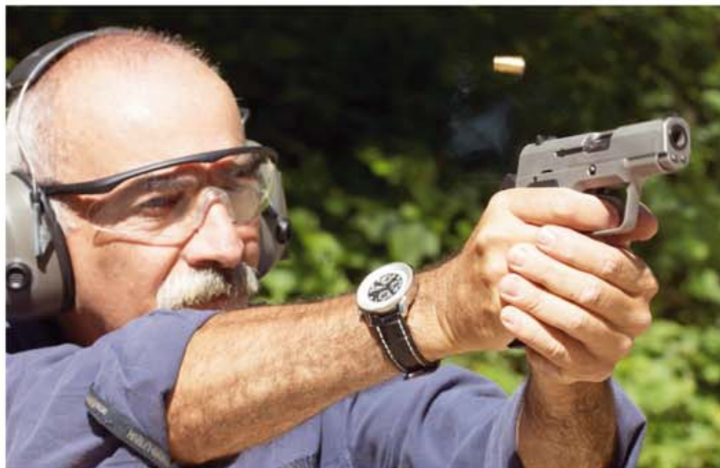
Schiessen mit der CrN-beschichteten Pistole. Dieses Finish ist besonders hart und kratzfest, wegen dem aufwändigen Verfahren aber auch teurer.
