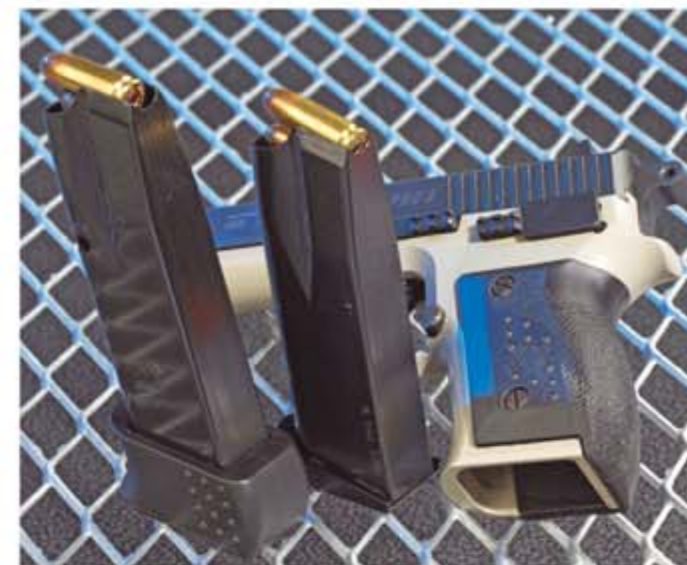
Das lange 15-Schuss-Magazin besitzt ein aufschiebbares Zwischenstück, das dem kleinen Finger der Schiesshand guten Halt ermöglicht.
